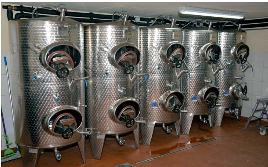
Moderné dvojetážové nerezové tanky s chladením slúžia hlavne na výrobu bielych vín.
